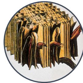
BILDE 2: Eksponert kledning hvor trecellen ytterst er ned- brutt og gir uegnet underlag uten nødvendig forbehandling.
